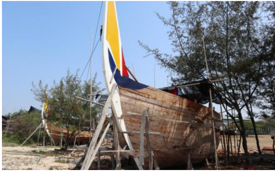
Gambar 6 Perahu Mayang dalam tahap pengerjaan (Purnawibawa, 2020)
